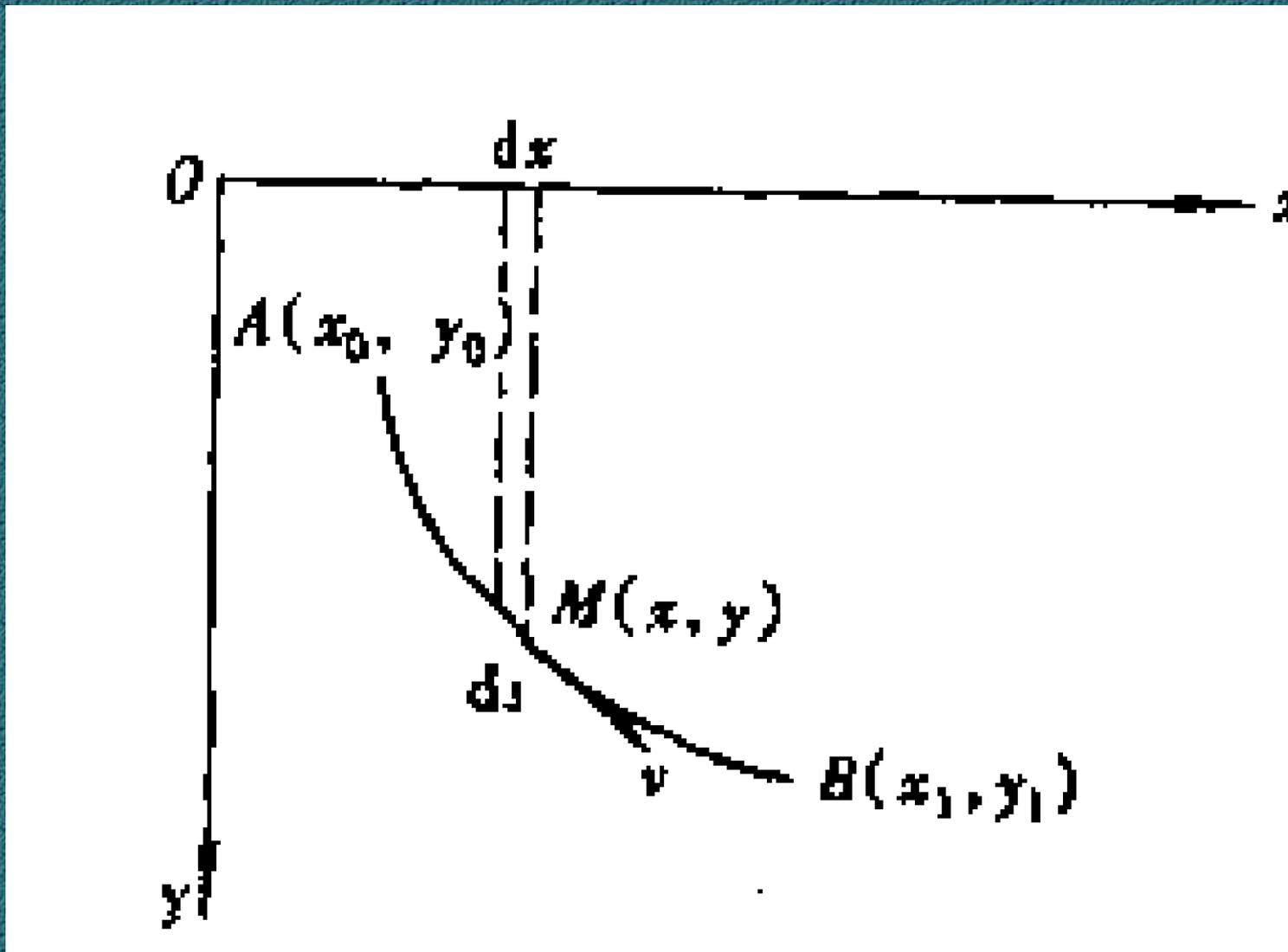
最速降线问题是：设  $O$  与  $A$  是高度不同且不在同一铅垂线上的两定点，如果没有摩擦和空气阻力，一质点在重力作用下从  $O$  点沿一曲线降落至  $A$  点，问曲线呈何种形状时，质点降落的时间最短？
